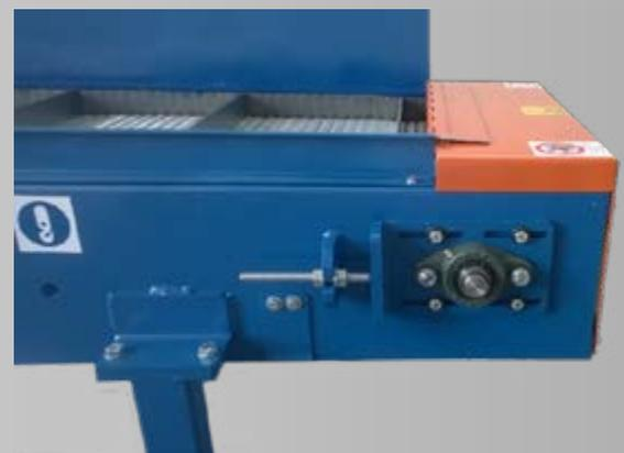
Gruppo trasportatore a DOPPIA SEDIA per carico ed evacuazione particolari da impianti di trattamento termico
